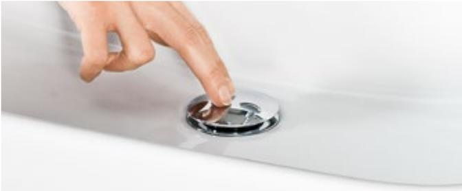
Neben dem klassischen Ablaufventil bietet DIANA ein intelligentes Verschluss-System für mehr Design: Die Push-Open-Technik verschließt den Abfluss durch sanften Druck auf den Ventildeckel. Dadurch wird die Zugstange der Waschtischarmatur überflüssig, die sonst sowohl an der Armatur wie unter dem Waschtisch sichtbar wäre. Bei erneutem Druck öffnet das Ventil wieder.
