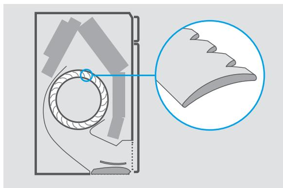
Schalldämpfung und Geräuschreduzierung als Ergebnis des neuen Ventilator-Designs.
